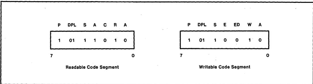
Figure 7-8. Access Byte Example
