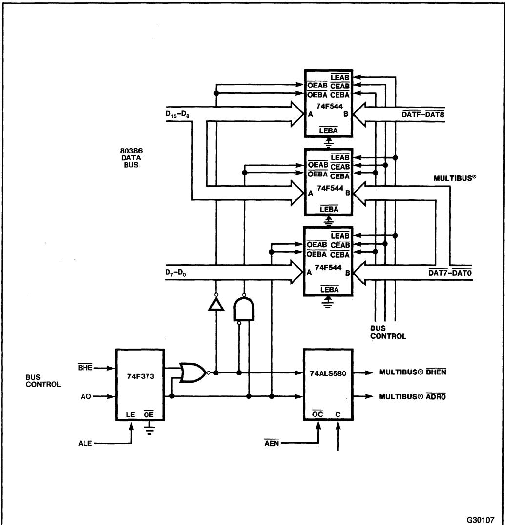
Figure 9-10. Byte-Swapping Logic
